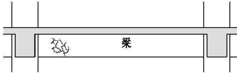
■ 表面水泥砂漿粉刷層施工不良
